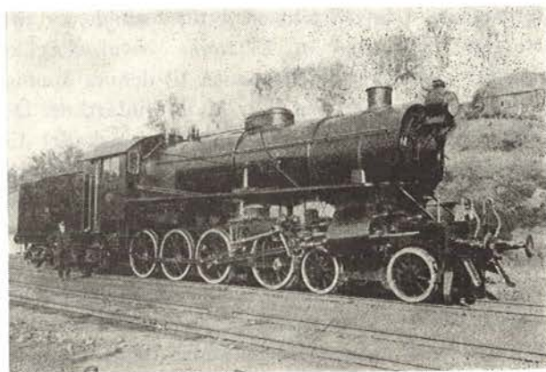
Fig. 6. Høyfjellslok, type 31-2'D/14 t. fra 1915.
