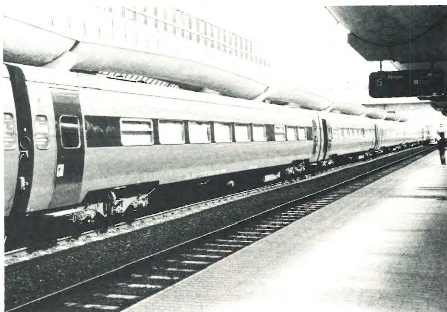
Tog 43 satt opp i spor 4, Oslo S. Det runde vognprofillet hindrer vaksemaskinen i å nå nederst på vognen, slik at det oppstår en utilsiktet staffering!
