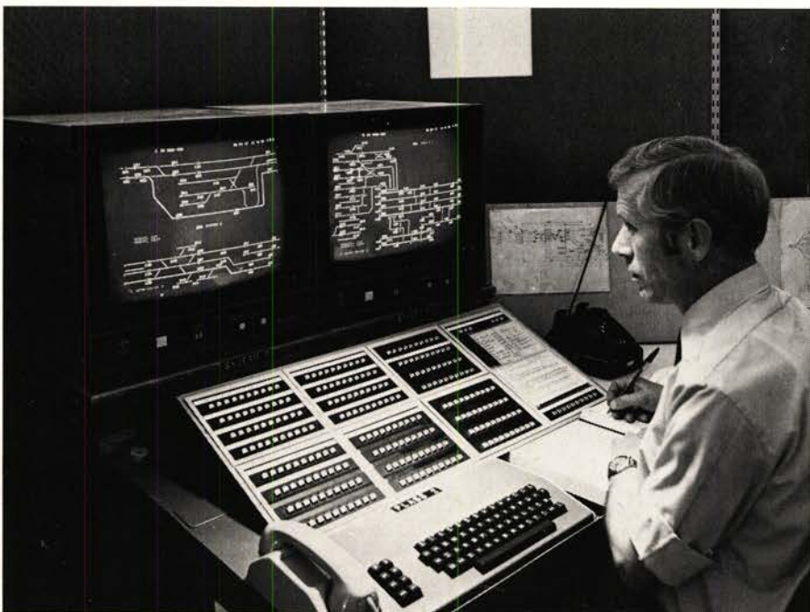
Fig. 8. Manøverbord for sikringsanlegg med linjetakerpanel
