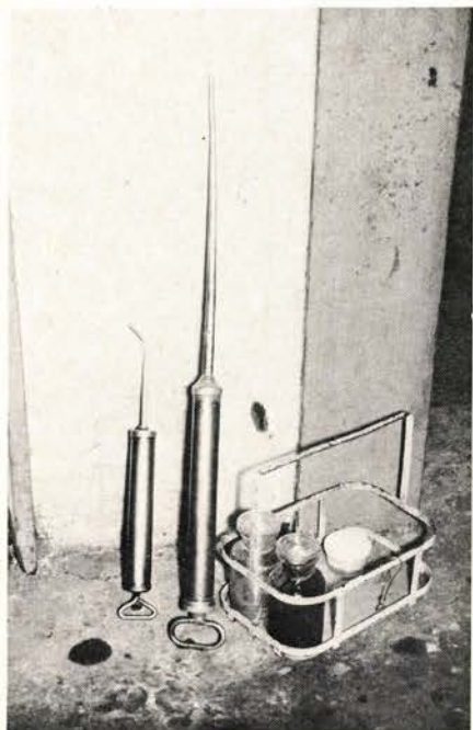
Fig. 1. Utstyr for uttak av oljeprove på NOHAB-lok.
