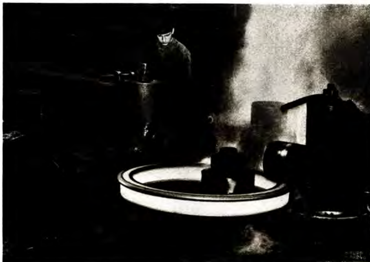
Valsning av en hjulring i Krupps hjulringvalseverk.
