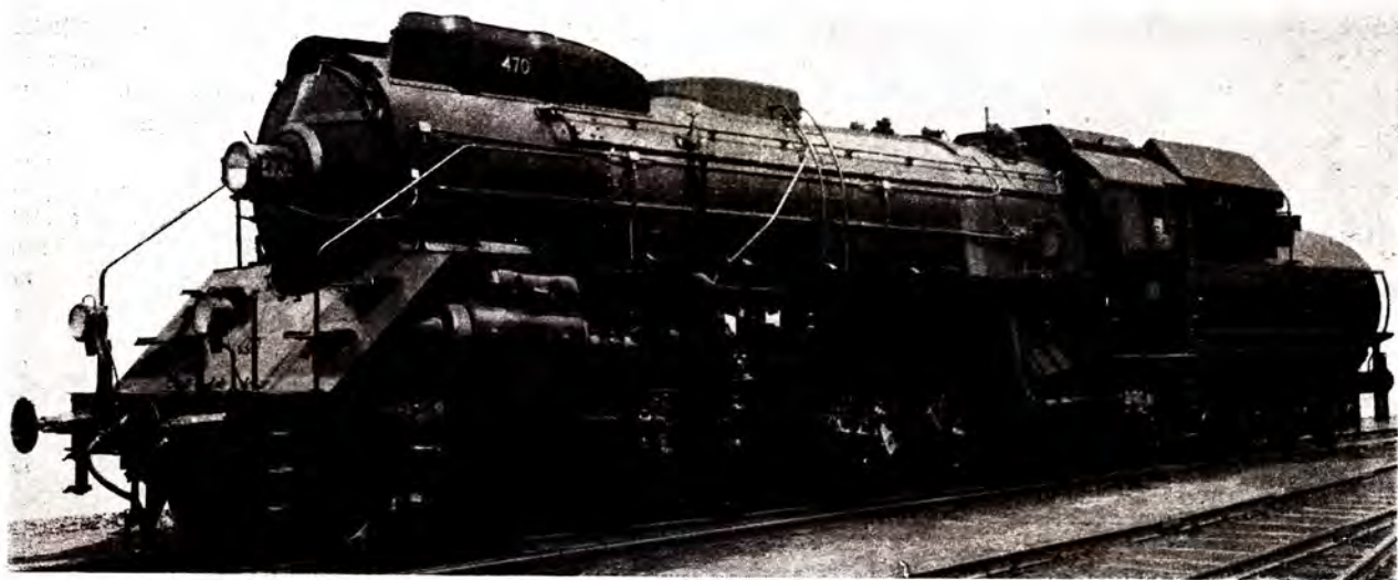
Fig. 1. 4-sylinder hurtigtogslokomotiv 1' D 2' (Dovregubbe)
