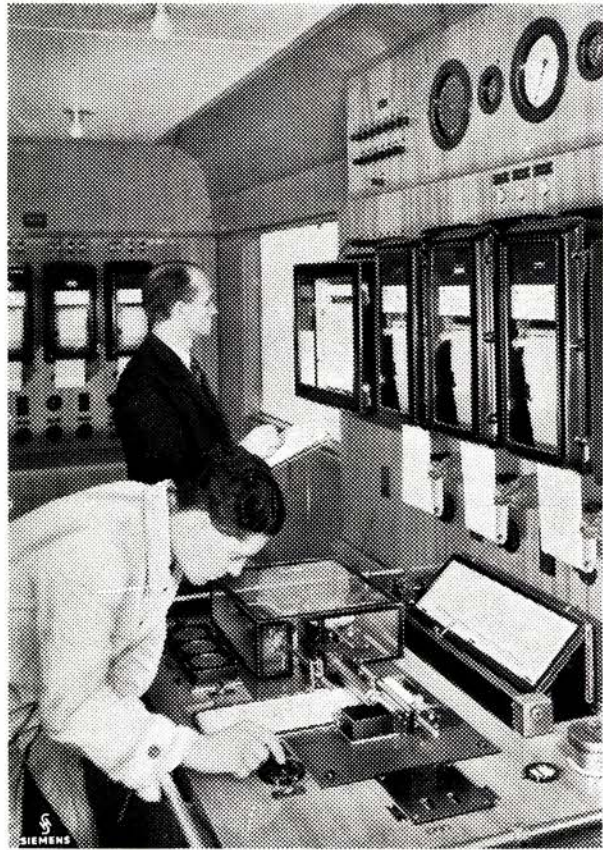
Fig. 3. Målebord for mekaniske målinger og registreringsapparater for hastighet, akselerasjon og trekkraft.
