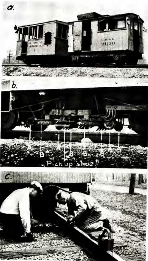
Fig. 1. a. Sperry skinnelrudd-vogn. b. Sperry børstevogn. c. Håndprøve.
