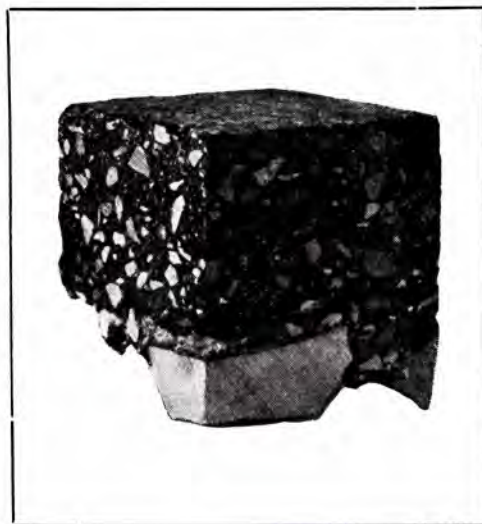
Prøve av Icobetong fra Drammensveien i Asker. Lagt i 1932. Prøven uttatt 1937. Trafikk over 1000 kjøretøier pr. døgn (gjennomsnitt i året). Intet vedlikehold siden legningen.
