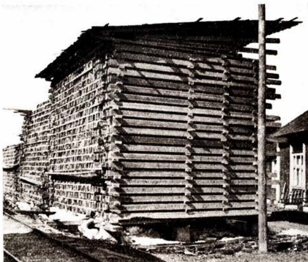
Planker stabled på kant.
