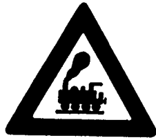
134.2 Jernbaneplanovergang uten grind eller bom.
