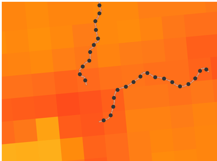
Figur 4.4: Hovedbanen og sørlige del av Gjøvikbanen, med km-segmentenes midtpunkter mot et temperatur-raster på en NetCDF-fil. Værdataene er hentet fra thredds.met.no og kartet er laget i ArcGIS Pro (ESRI, 2018a).
