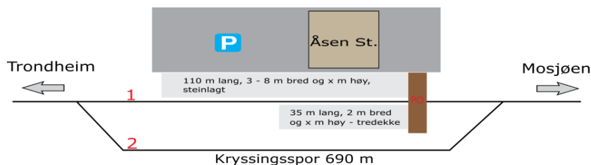
Figur 16: Eksempel på kryssingsinstruks, Åsen stasjon
