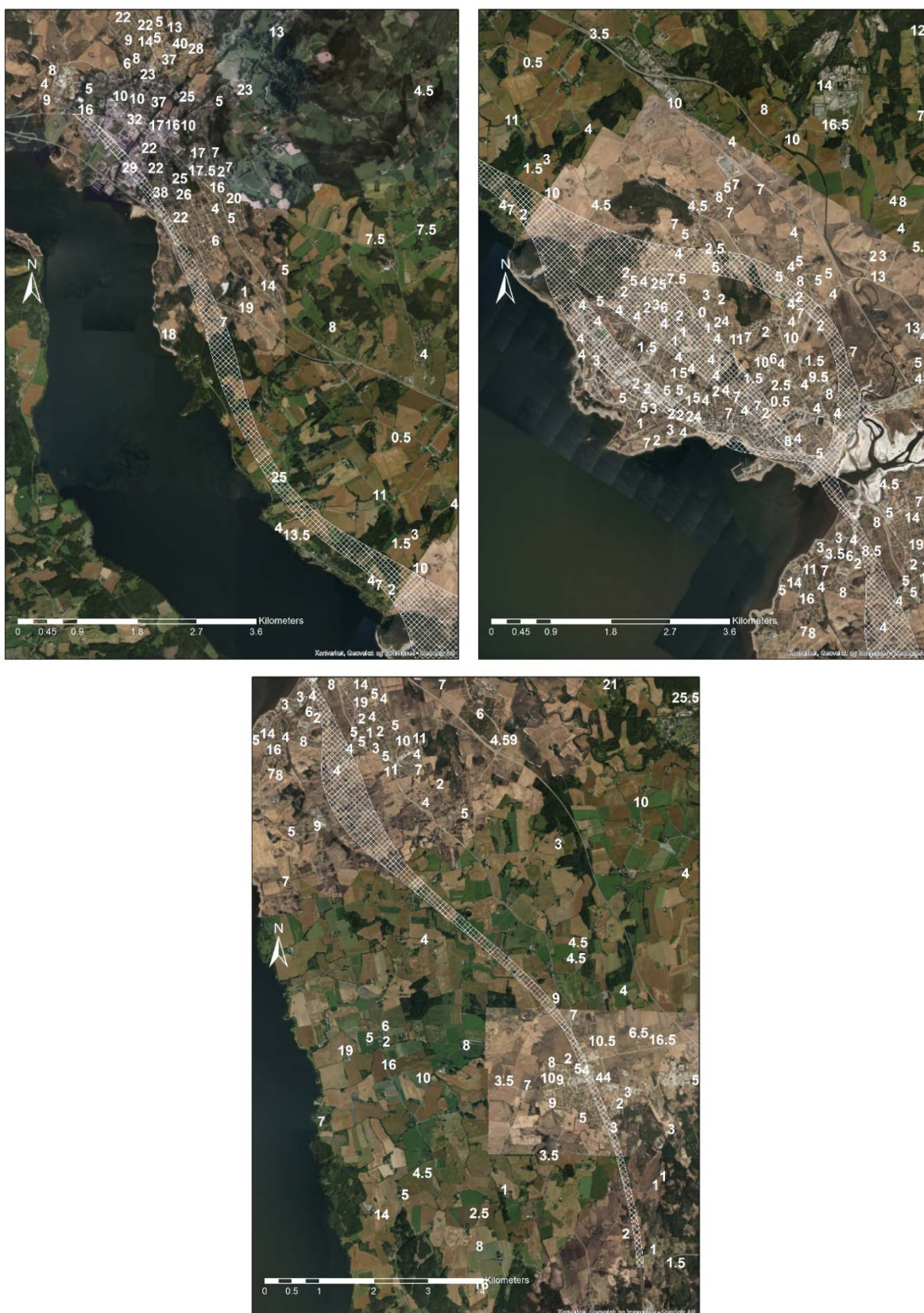
Figur 17: Dybde til fjell. Tallene er hentet fra NGUs brønndatabase Granada og viser dybde til fjell avrundet til nærmeste halve meter. Tallene er plassert rett over posisjonen av brønnene [4]
