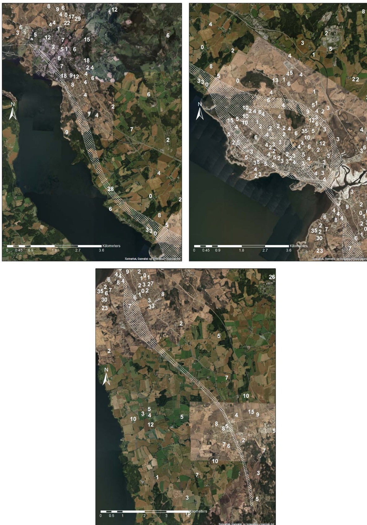
Figur 18: Vannstand. Tallene er hentet fra NGUs brønndatabase Granada og viser stabil grunnvannstand etter boring avrundet til nærmeste halve meter. Tallene er plassert rett over posisjonen av brønnene [4]
