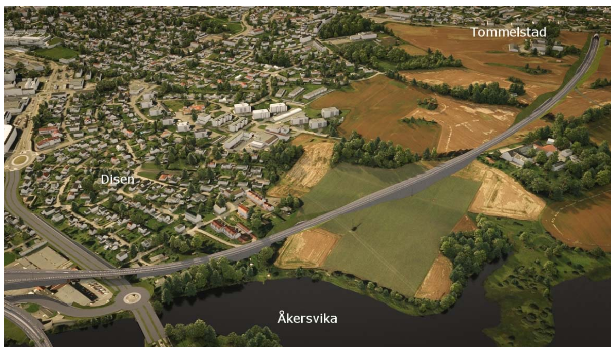
Figur 4-17 Jernbanen anlegges på bro over Vangsvegen og fortsetter deretter på vekselvis fylling og skjæring over jordene til Børstad og Tommelstad gård.
