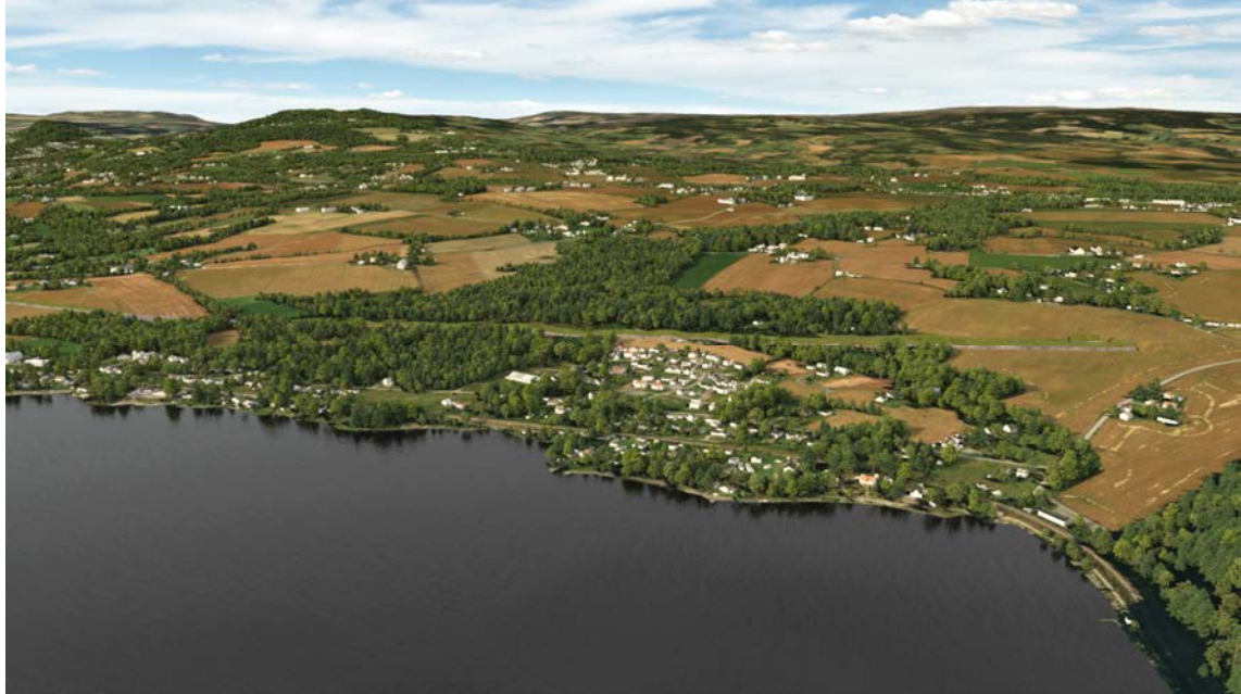
Figur 5-92. Jessnes sett fra Mjøsa. Nytt dobbeltspor (tynn, grønn strek) ligger i moderat skjæring gjennom jordbrukslandskapet og svekker karaktertrekkene i liten grad.
