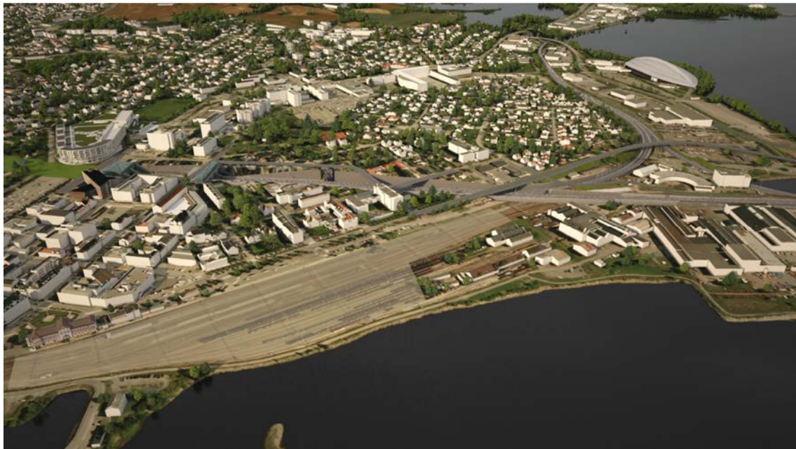
Figur 5-47. Alternativ K2 midt-1a stasjon ved rådhuset med nedsenket sporområde gjennom Østbyen innebærer et betydelig kutt i landformen fra Espern til Vangsvegen. Fjerning av eksisterende jernbaneanlegg åpner samtidig opp for en visuell og funksjonell kontakt mellom byen og Mjøsa med omland.
