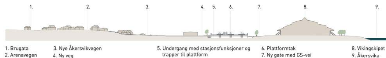
Figur 5-25. Snitt gjennom Briskebyen-Vikingskipet-Åkersvika som viser alternativ K3 øst-3 stasjon ved Vikingskipet. Nytt stasjonsområdet heves omkring 3,3 meter over dagens terreng. Vikingskipet og arealene omkring har en stor skala og ligger på oppfylt terreng, og tiltaket bidrar derfor i liten grad til å svekke landskapets karaktertrekk.
