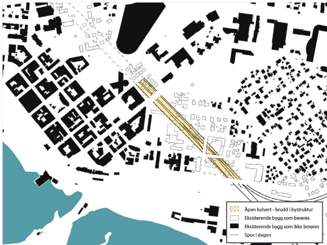
Figur 5-42. Ved alternativ K2 midt-1a stasjon ved Rådhuset vil en rekke enkeltbygninger bygninger og enkelte hele kvartaler rives. At kvartalsstrukturen i Østbyen i liten grad synliggjøres av bygningsmassen, begrenser den visuelle virkningen av saneringen.
