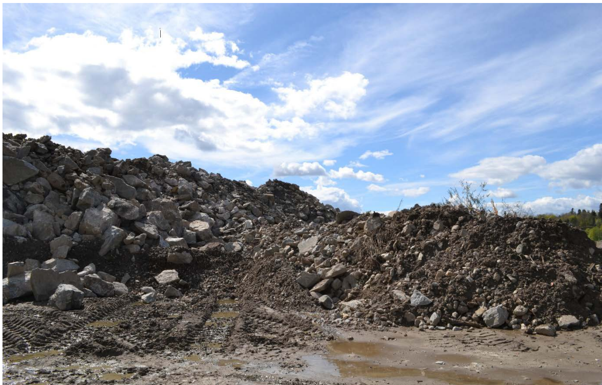
Figur 4-4 Stein- og blokkmateriale utsortert fra morenemateriale som knuses til pukk sammen med sprengstein.
