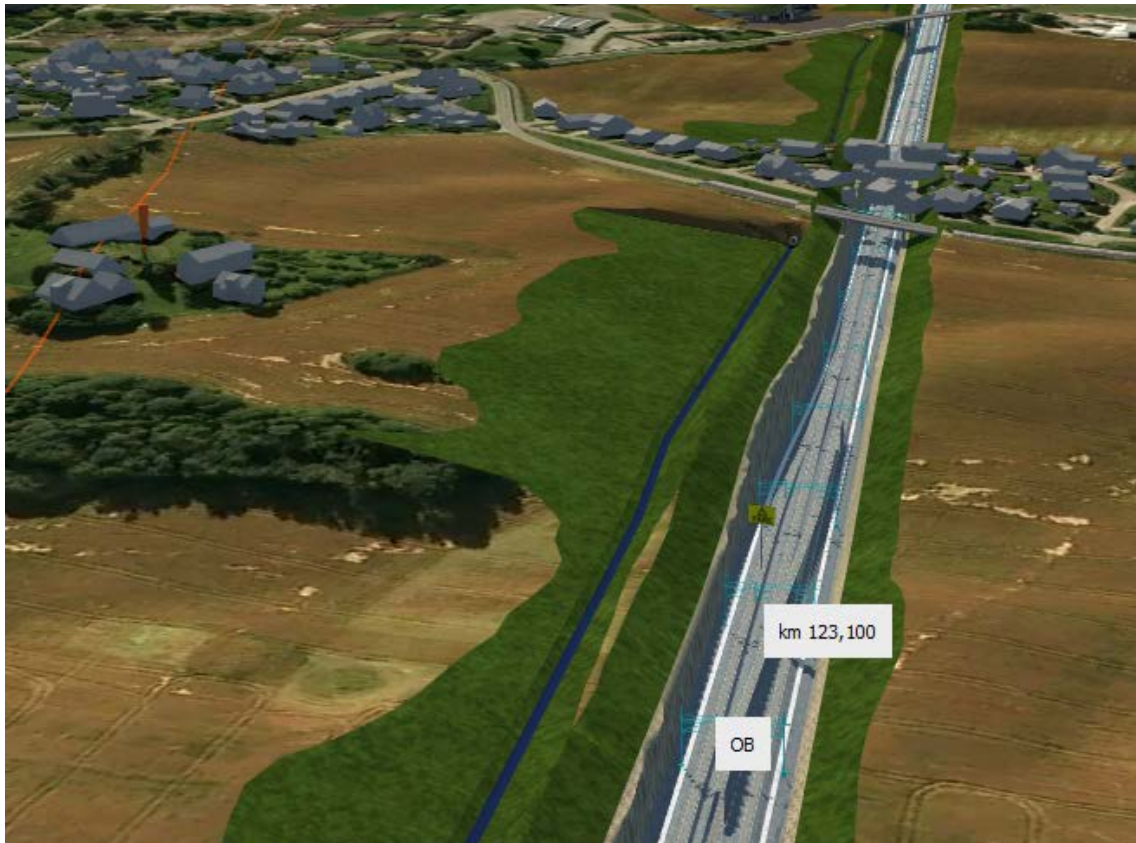
Figur 5-2 Omlegging av Brenneribekken vest for alternativ 1a og ny drenering øst for sporet, sett mot sør.
