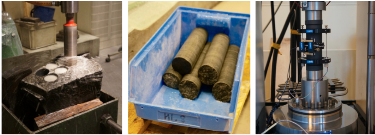
Figur 6.2: Preparering av steinprøve til UCS-test. Trykkcellen som ble brukt for enaksielt trykkforsøkt er vist i bildet til høyre.
