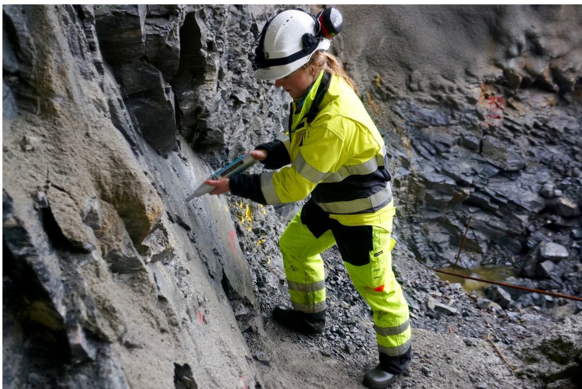
Figur 5.5: In situ måling av Schmidt hardhet ved Fløen.
