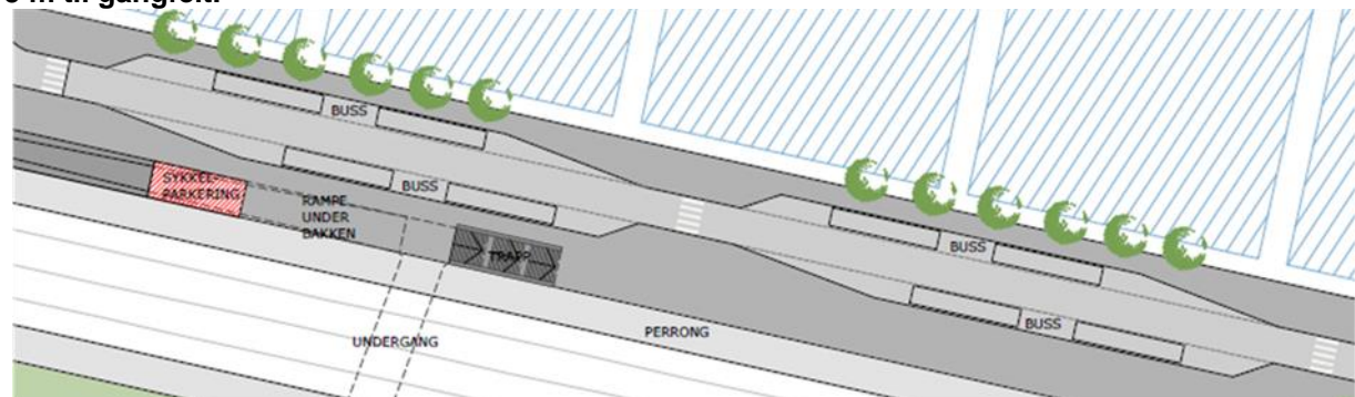
Figur 6-16: Dimensjoner: 20 m innkjøring, 67 m bussoppstilling til tre busser, 5 meter utkjøring, 5 m til gangfelt.
