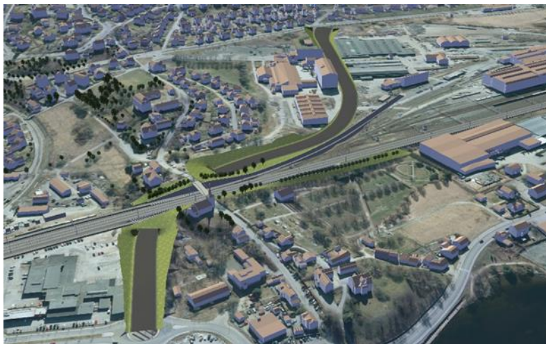
Figur 9: Illustrasjon Sundland Vest. Tiltaksvei vest er ikke del av tiltaket, men veikulverten må etableres samtidig med byggingen av ny Vestfoldbane fordi det vil være svært krevende å bygge veien her etterpå
