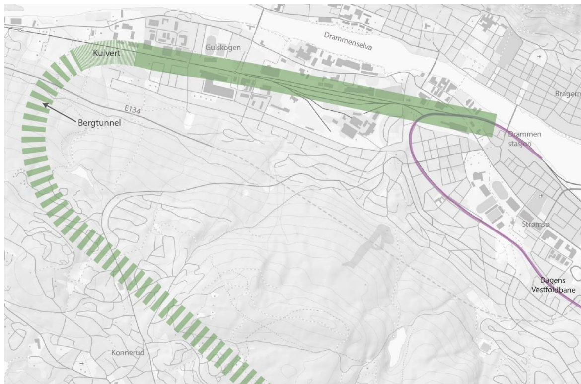
Figur 20: Dagsone, kulvert og bergtunnel for første del av korridor Pukerud.
