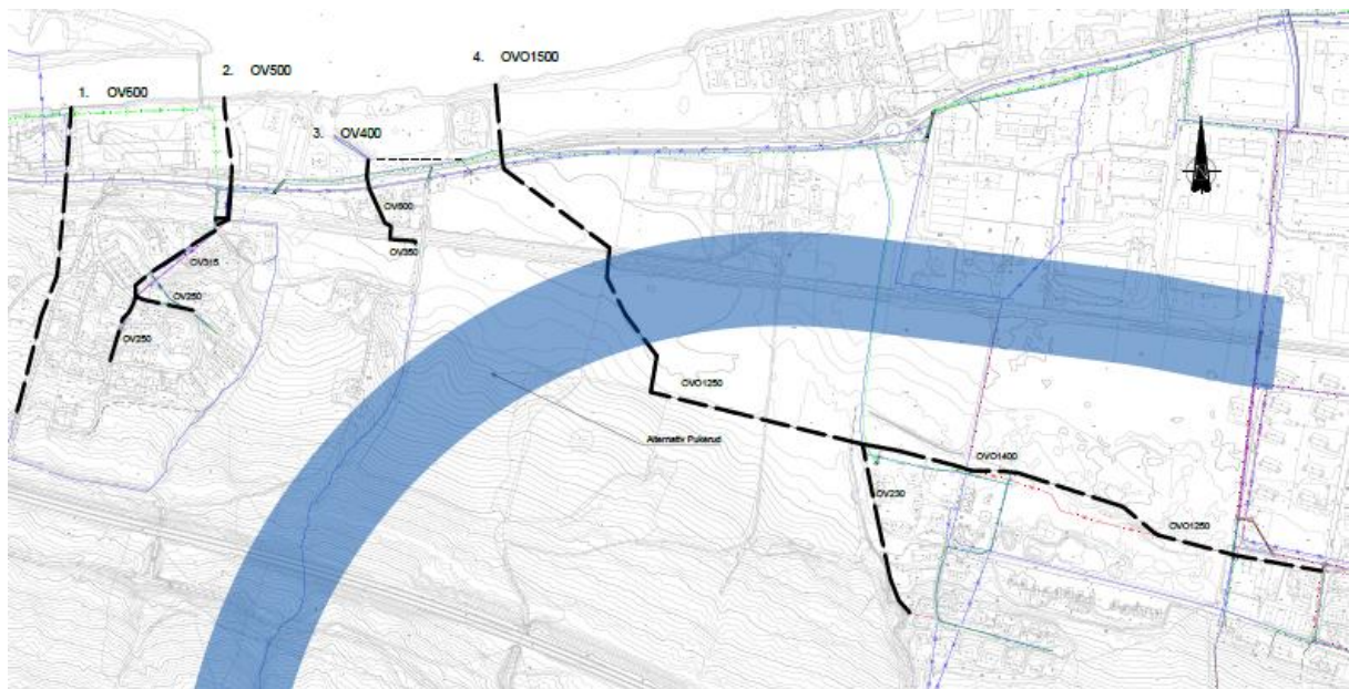
Figur 8: Kryssende utslippsledninger ved Pukerud
