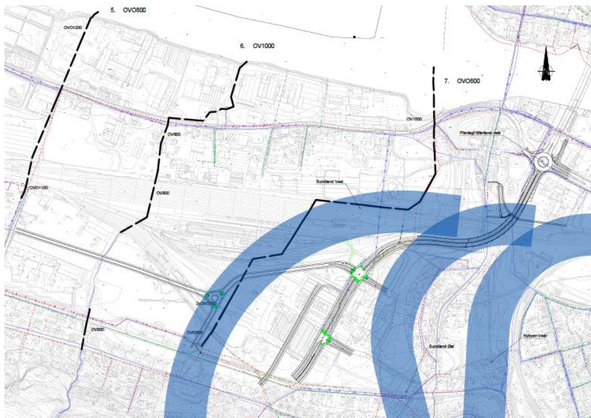
Figur 9: Kryssende utslippsledninger ved Sundland
