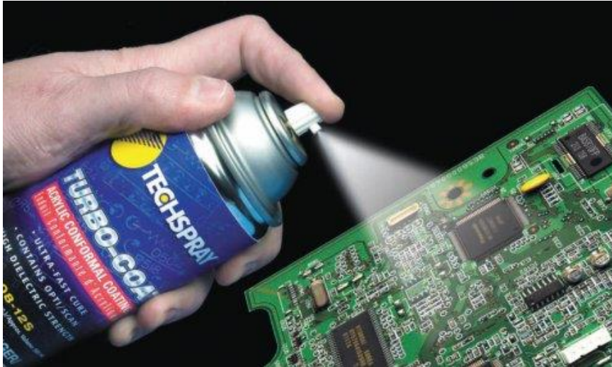
Figur 54 - Spraying av akryl-belegg 111
