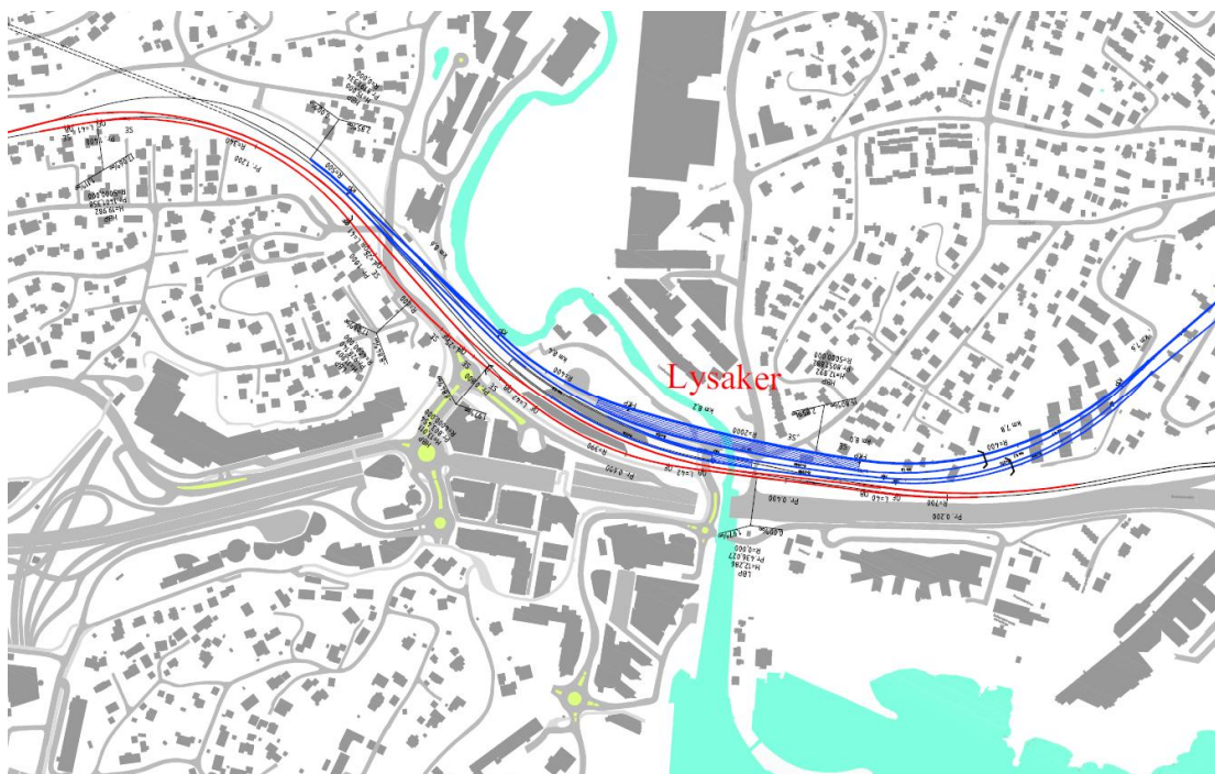
Utvidelse av Lysaker stasjon. Blå farge er regiontog og rød farge er lokaltog.
