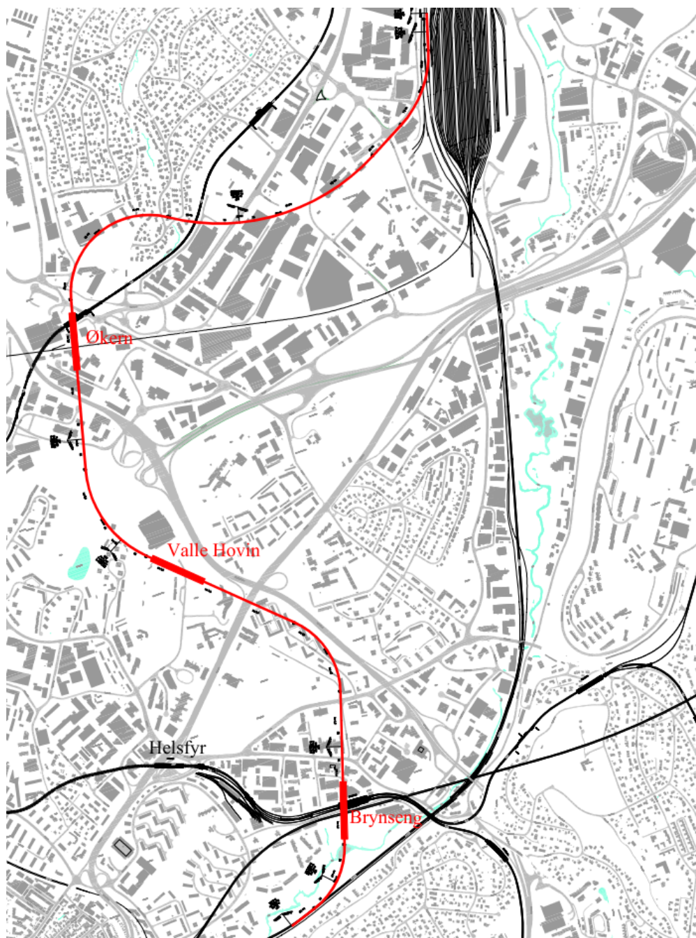
Figur 69: Oversiktstegning omlegging av Hovedbanen/S-bane Bryn-Økern-Alna
