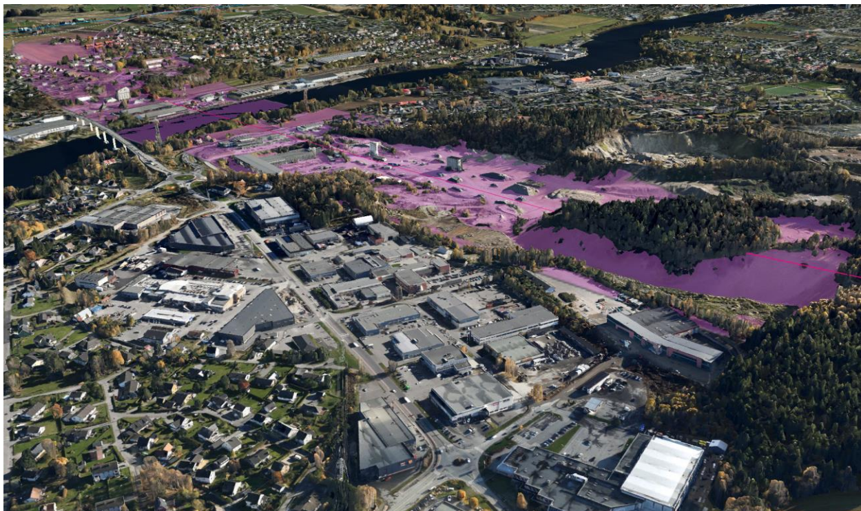
Figur 10-10. Nenset, her er traseene like for alternativene M.1 og M.2. Bildet viser influenssone (200 meter radius) og dagsone ved kryssing av Skienselva. Illustrasjon: COWI AS.
