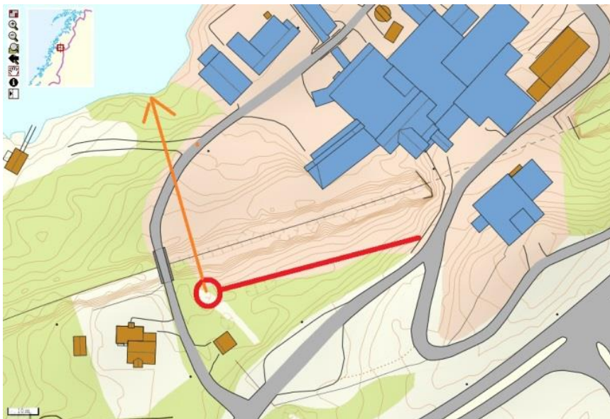
Figur V- 85) Svart tynn linje er jernbanesporet. Rød linje viser plassering av en åpen terrenggrøft, og rød ring viser inntak til vanntunnel. Oransje pil viser omtrentlig plassering av vanntunnel under sporet ned til fjorden (Norges geologiske undersøkelse, 2016).
