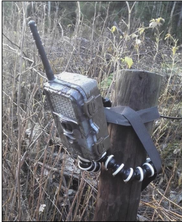
Figur 20. Viltkamera festet med GorillaPod og festebånd.
