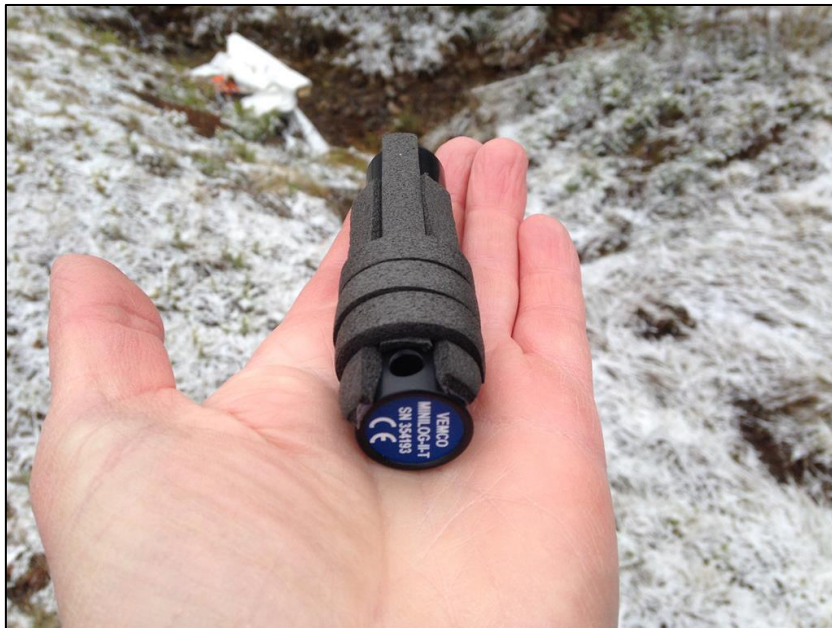
Figur 17. Bilde av temperaturloggere som er benyttet i stikkrennene og i luft. Her med isolasjon mot betongtaket i stikkrenner. Foto: Bent C. Braskerud, (2013).
