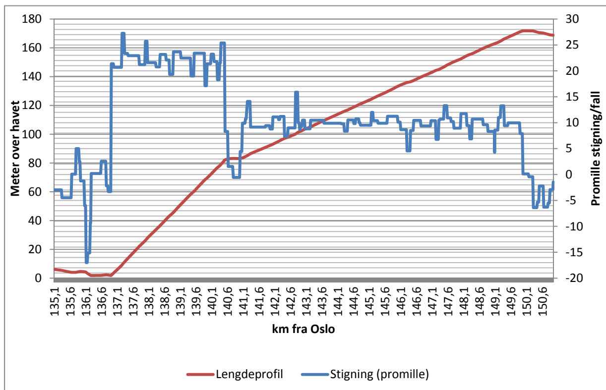
Figur 1 - Lengdeprofil og stigning Tistedalsbakken Halden-Aspedammen. Halden stasjons ende mot Tistedalsbakken ligger ved km 136,84 (Jernbaneverket).
