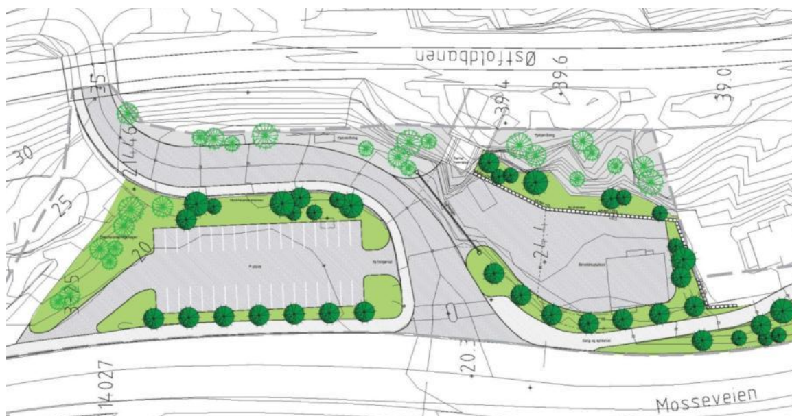
Figur 60 Landskapsplan som viser istandsetting av arealet som planlegges brukt til rigg- og anleggsområde ved Furubråtveien. Illustrasjon: Jernbaneverket/Aas-Jakobsen
