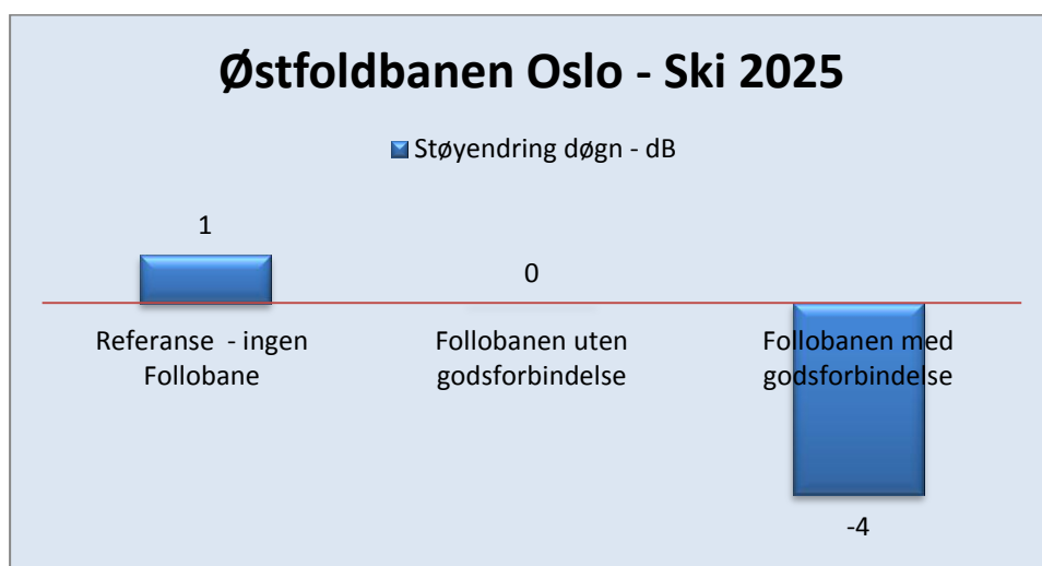
Figur 73 Endring i støybelastning på døgnbasis langs Østfoldbanen i forhold til dagens situasjon. Illustrasjon: Jernbaneverket/Asplan Viak
