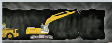
5. RENSK AV FJELLET Fjellet pigges ned med hydraulisk hammer.
