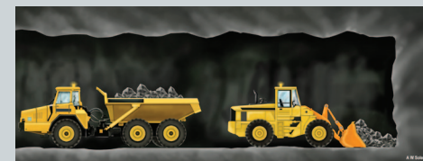
4. UTLASTING Massene transporteres ut av tunnelen. Kjøreruten til godkjente deponier er definert på forhånd.
