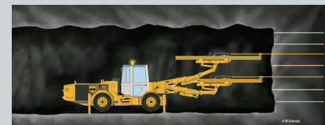
2. BORING OG LADING Det bores 5 meter lange hull som lades med sprengstoff.
