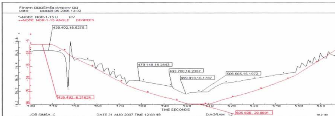
Figur 10-5 Spenning og fasevinkel ved 15 kV samleskinne ved Nordagutu omformerstasjon. De uvanlige spenningsdippene som oppstår ved tiden t = 460 til 470 sekunder og t = 550 til 570 sekunder kan tilskrives spenningsregulatoren og trinnkoblingene som skjer på Neslandsvatn transformatorstasjon.
