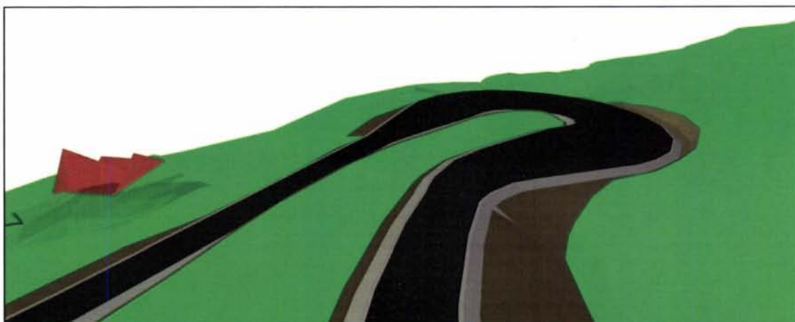
Figur 6.15: Sett ovenfra. I kurven er det foretatt breddeutvidelse tilsvarende typekjøretøy ST og VT.
