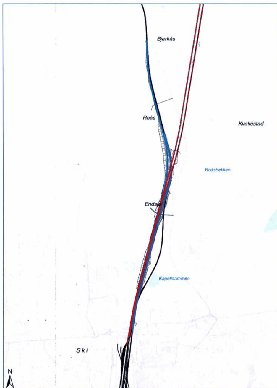
Figur 19 Innføring Ski. Stiplet linje viser tunnelstrekning. Rød heltrukket linje viser dagsone for Follobanen og blå linje viser en optimalisert Østfoldbane.
