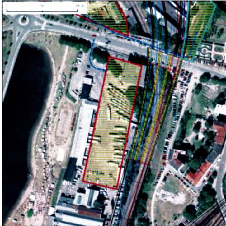
Figur 20 - Rigg- og anleggsområdet ved Bispegata og Middelalderparken
