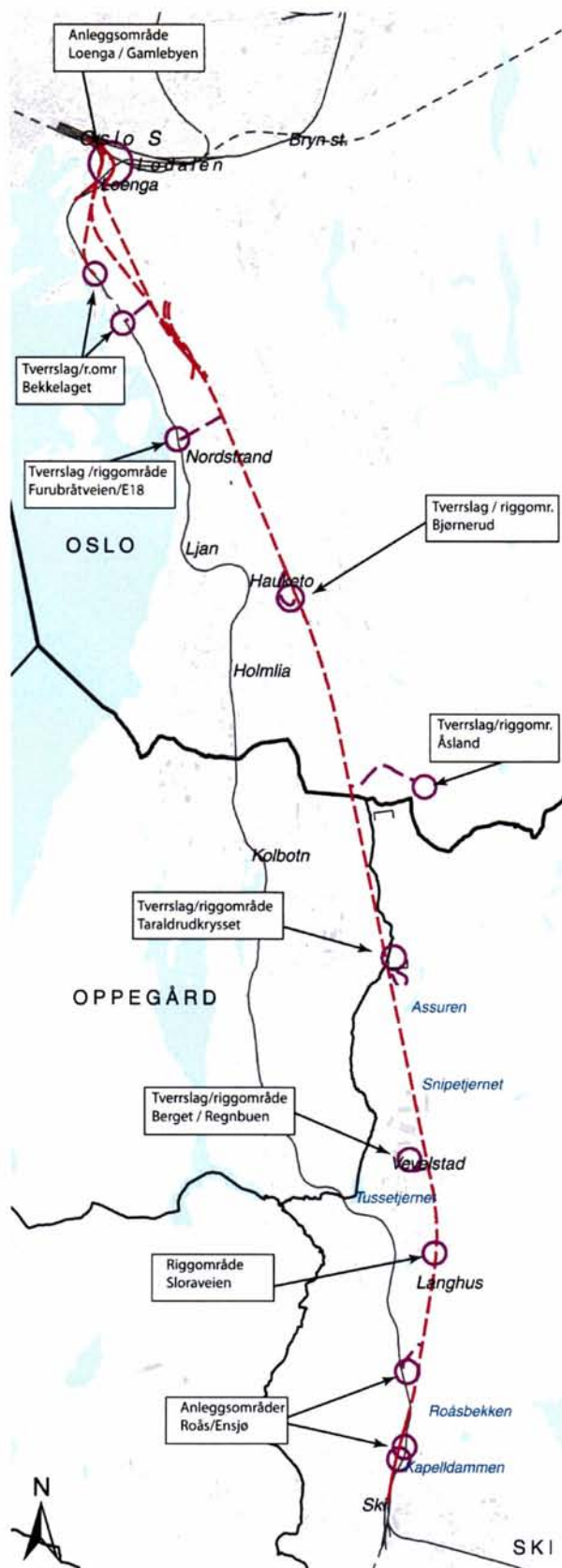
Figur 7-A. Oversiktskart som viser tiltaket som skal utredes med plassering av rigg- og anleggsområder, samt tunneler for eventuelle tverrslag
