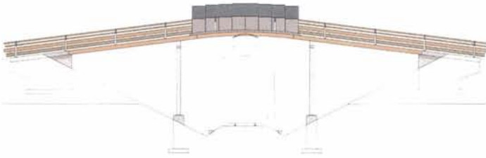
Fig 1.1. Eksempel på plate/bjelkebru i 3 spenn.
