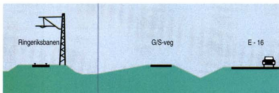
Figur 12 Tverrsnitt av Ringeriksbanen og E16 over Steinsletta
