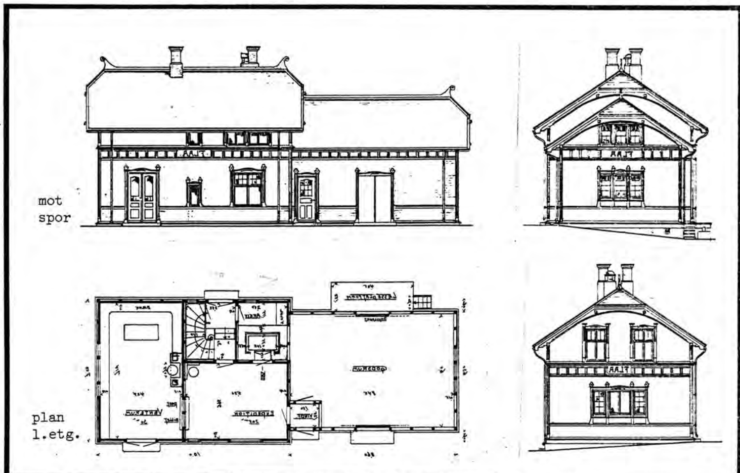
TEGNINGEN VISER: Original-tegninger, datert 23/11 1906. Målestokk 1:200
