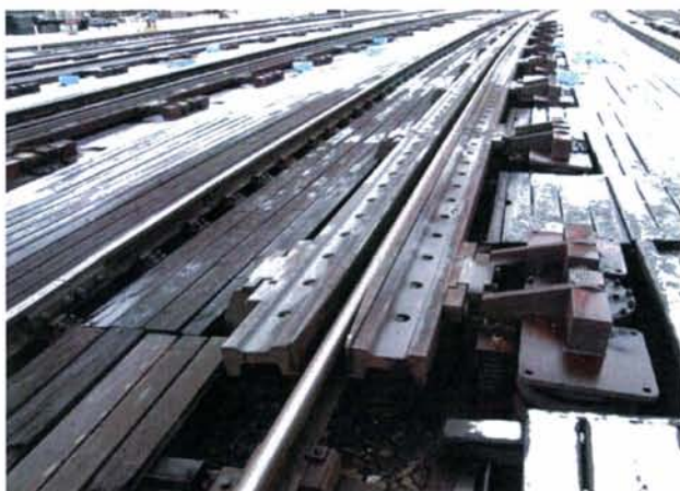
Figur 5 Fastholdebremsen er en bjelkebrems som klemmer mot vognhjulen
