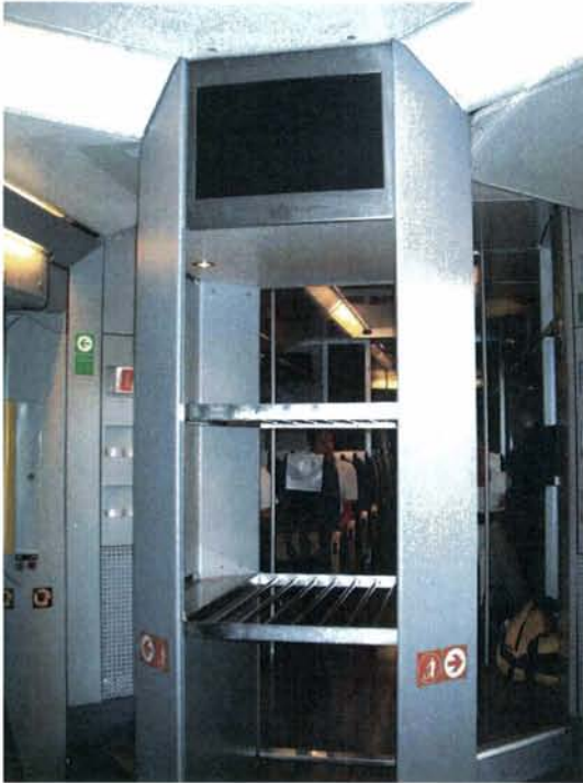
Figur 3: Bagasjesøyle med monitor i togets vestibyle.
