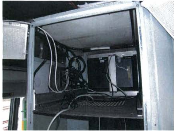
Figur 4: Den ene monitoren er demontert. I rommet mellom monitorene finnes ledninger og utstyr for strømtilførsel og signaltilførsel. Over dette rommet finnes varme- og kjøleelementene i togets HVAC-anlegg.
