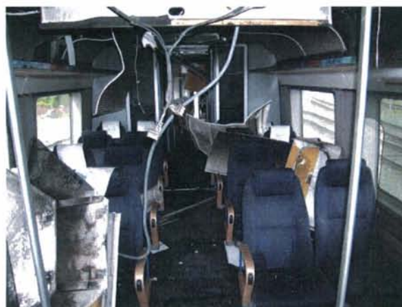
Figur 2 Røykskader og skader etter slukking i passasjeravdeling en i BM 71003.
