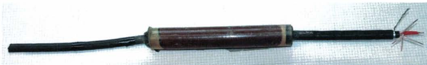
Figur 1 Oversiktsbilde av kabelmuffe mottatt for undersøkelse.
