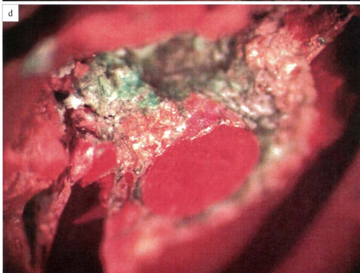
Figur 7 a-d: Ledere med tydelig irrdannelse observert i stereolysmikroskop på snitt vist i Figur 5k.
