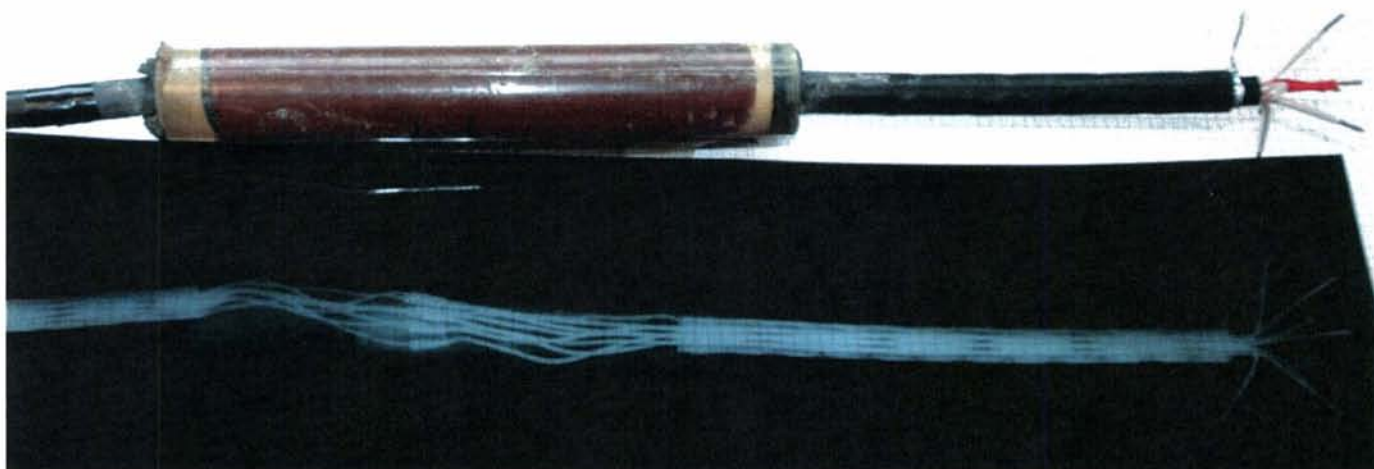
Figur 2 Bilde av kabelmuffe med røntgenbilde som viser ledere med skjøter i muffen.
