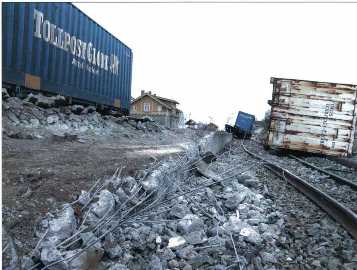
Figur 4: Til venstre sees vognen som stanset i spor 1, og til høyre containeren som veltet med tilhørende vogn i bakgrunnen.
