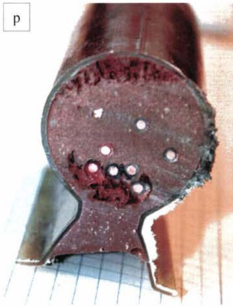
Figur 5a-p Bilde av snittflater etter seksjonering av kabelmuffe som vist i Figur 4.
