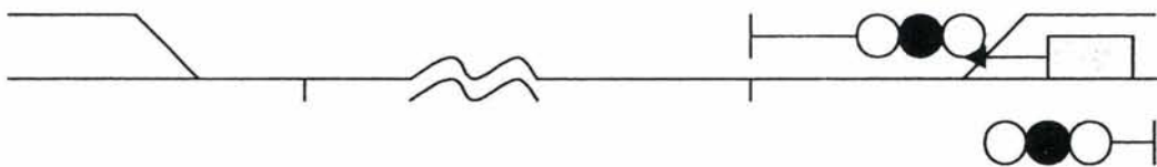
Figur 9 Figuren viser arbeidstog som skal ut på strekning som er belagt, for eksempel av skinnelbrudd, for å utføre arbeid.
