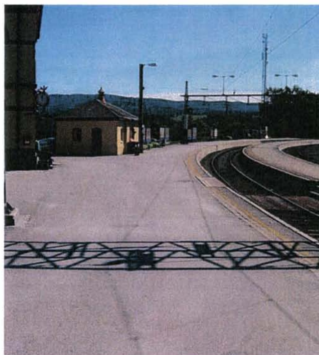
Fig. 11 Måling av avstand mellom togsid og plattformkant er ikke utført pga. praktisk gjennomførbarhet, men måling av avstand mellom spormidtd og plattformkant er utført.
