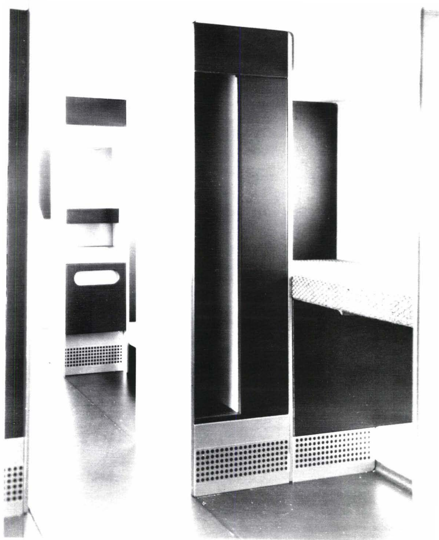
Kupéer sett fra korridor. Dørene står åpne når korridoren ikke er i bruk. Dørene kan enten lukke kupéen helt, eller bare lukke garderobeskapet, hvis passasjeren f. eks. er i restauranten eller baren.
