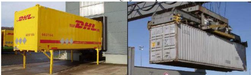
Figur 3: Vekselbilde med støttebein og 40 fot ISO-container.
