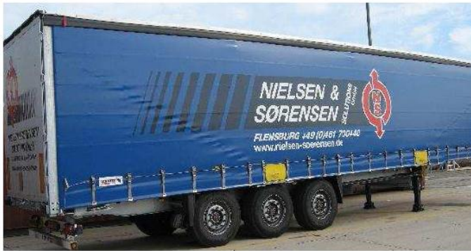
Figur 2: Semihenger med støttebein. Gripearmslommer markert med gult.
