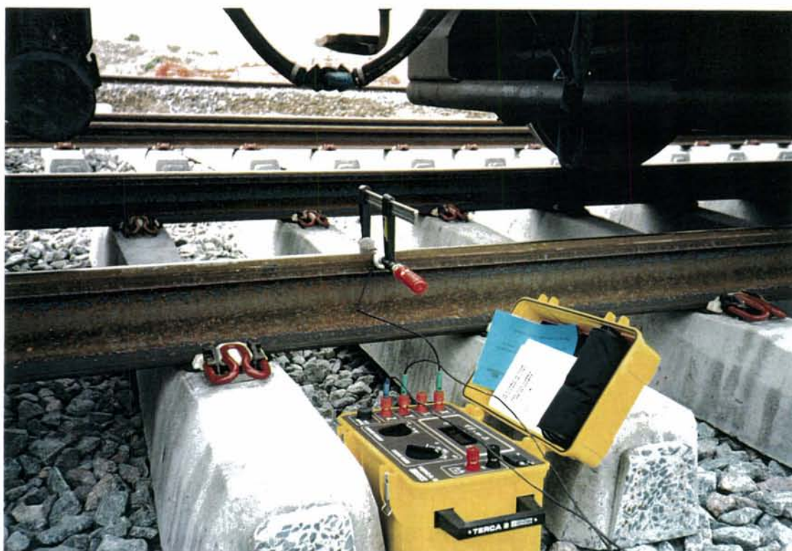
Bilde 6: Tilkobling til Terca 2 og til togskinne
