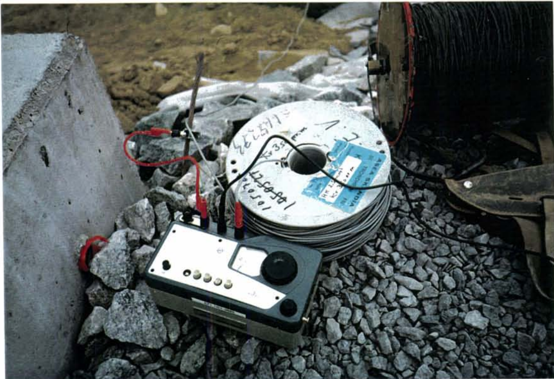
Bilde 2: Tilkobling til Norma jordplatemåler
