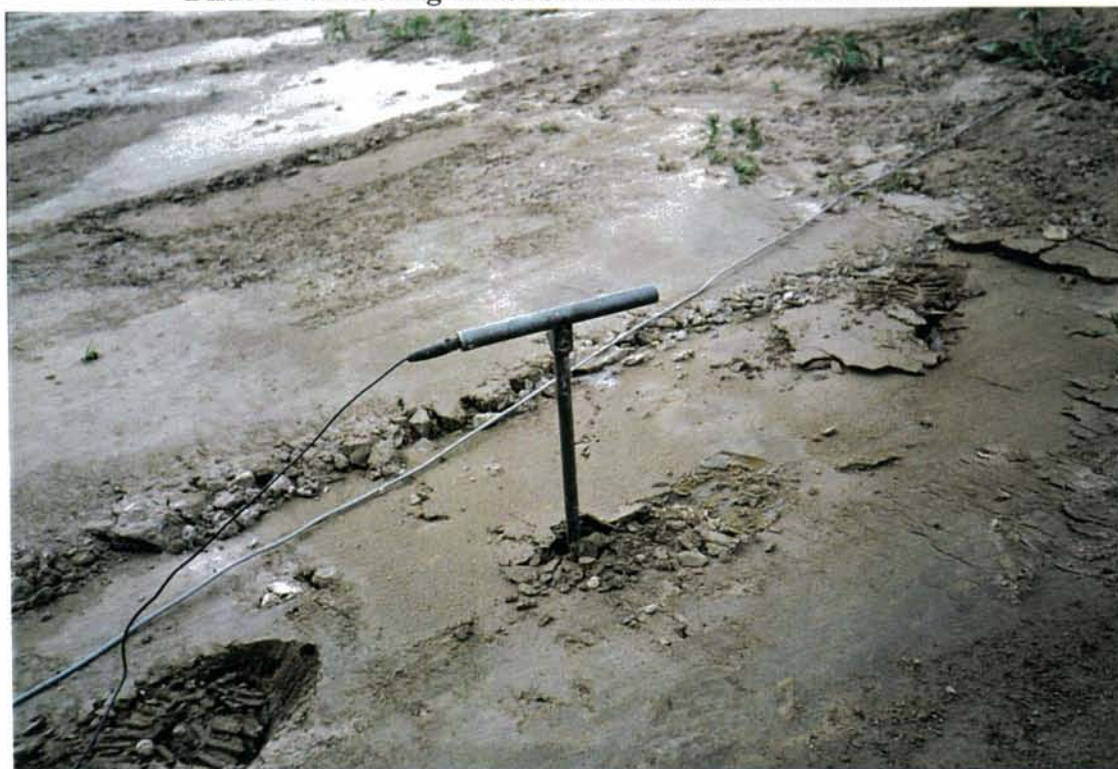
Bilde 4: Tilkobling til måleelektrode, spyd
