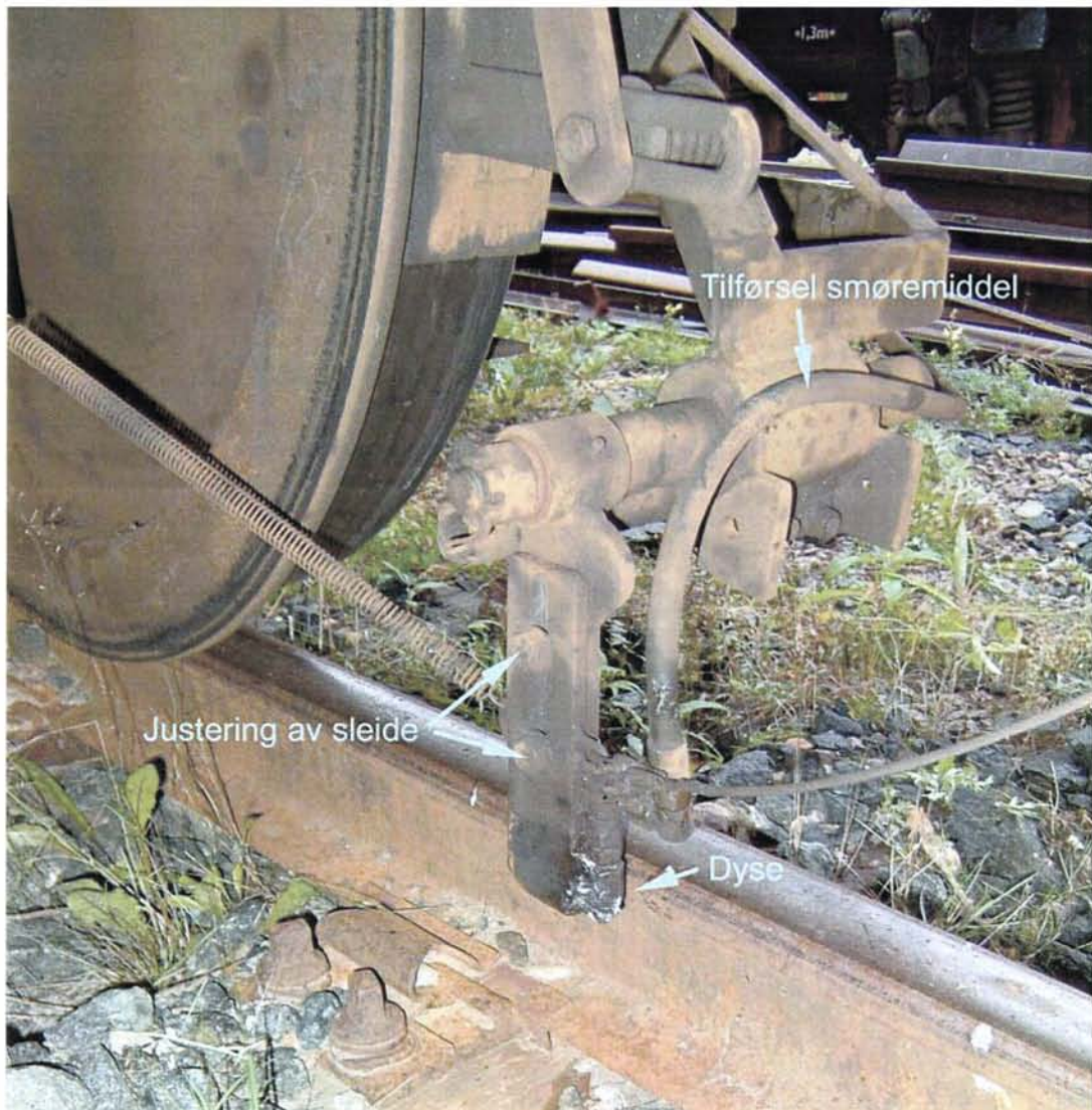
Figur 6-2 BaneService sin smørevogn. Detalj fra påføringsanordning. Foto: Geir Røer.
