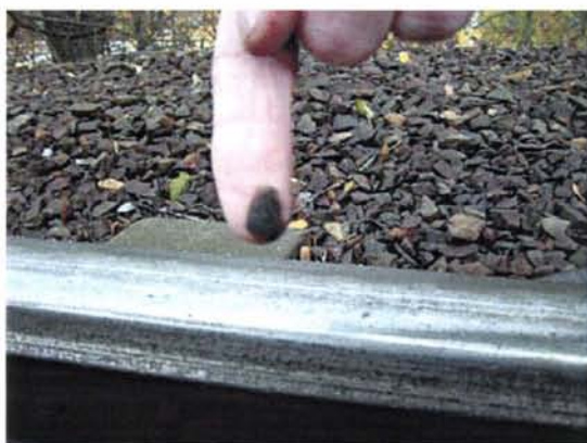
Figur 10-2 Fingerkontroll av smøring på skinne
