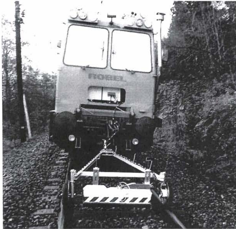
Figur 3. Antennevogn med antennearray montert på Robel lastetraktor.
