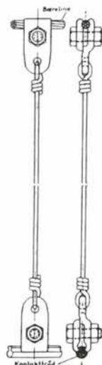
Fig. 93 Kontaktledning på master
