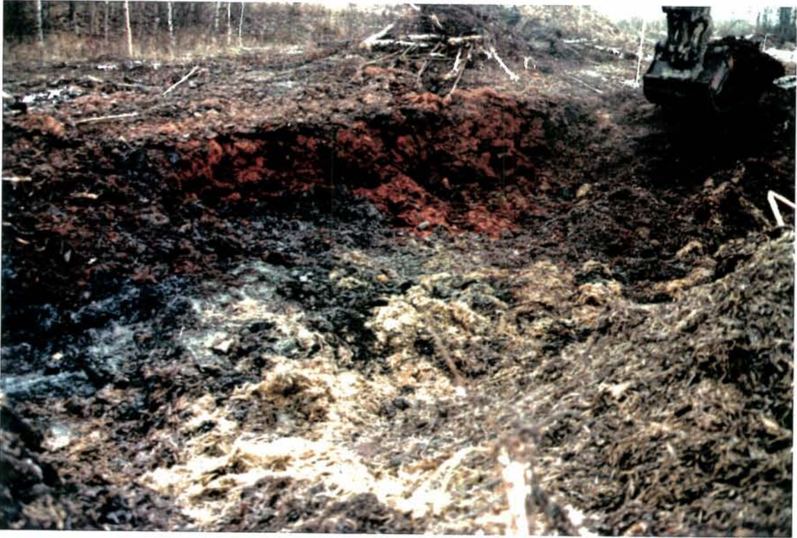
Oppgraving i F2. Graving topplag flis.
