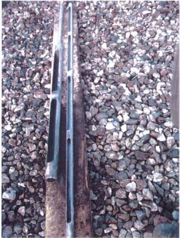
GEOTOOL minirigg med henholdsvis 2'' og 1'' sylindreprøvetaker fra venstre mot høyre.
